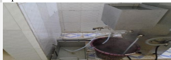
Photo 5. Manipulation dangereuse des effluents chauds.
